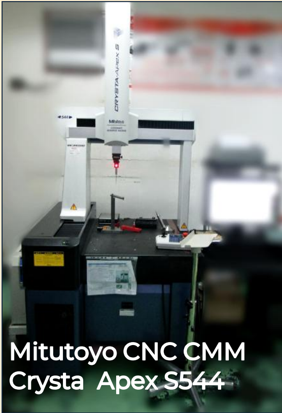
Mitutoyo CNC CMM Crysta Apex S574
